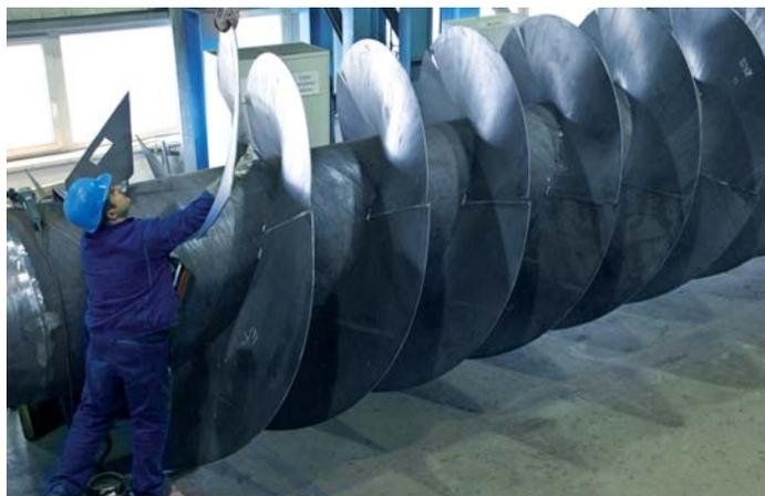
Die Flügel der Schneckenpumpen werden präzise gewölbt und ausgerichtet. . .
