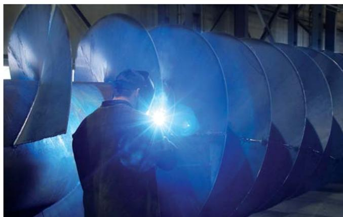
. . .dann auf den Schneckenkörper aufgeschweißt und. . .
